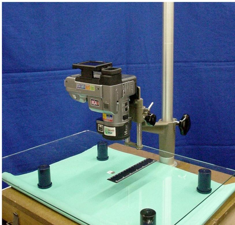
**Fig. 13** – Montagem do equipamento para o registro digital da imagem do linfonodo.
